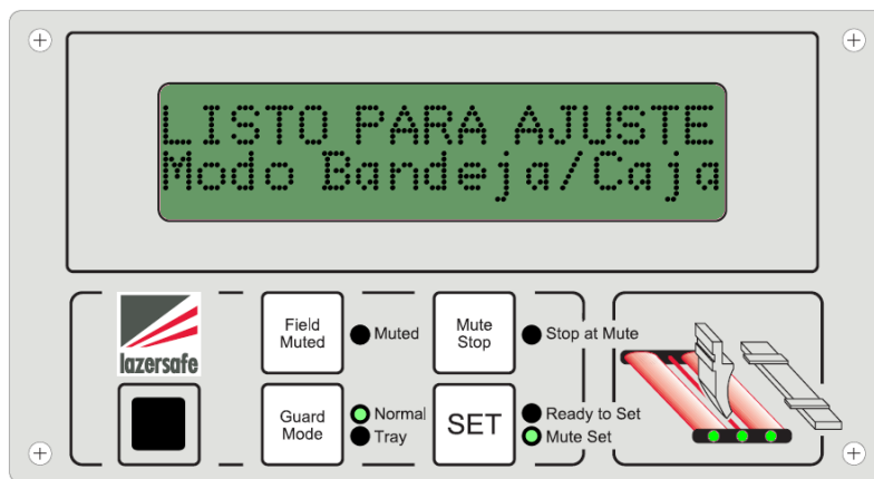
Imagen 4-25: Desconectar el Modo de parada en el punto de desconexión (Modo Bandeja/Caja)
