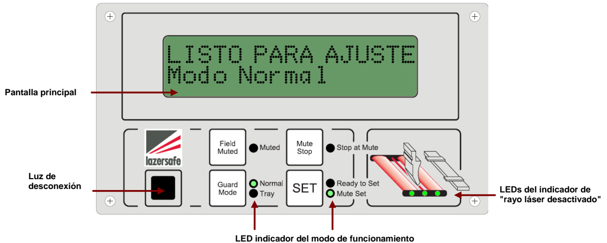
Imagen 4-1: Panel del operario LZS003
